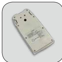
使用高稳定锂离子电池，电池容量高达3000毫安时，在实际使用中可达18小时以上的使用时间，即使在深山或无电源处也照样安心使用。
