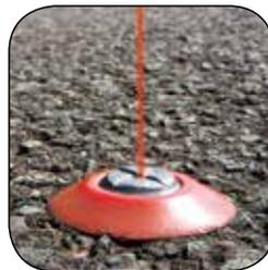
借助仪器内置的激光对中器可快速完成测站设立。
